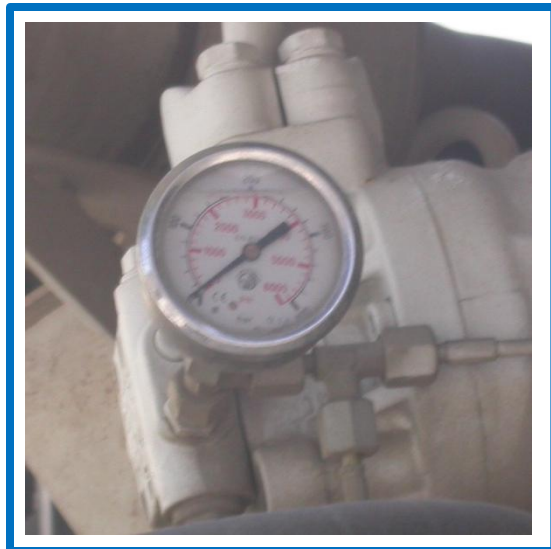
Manometro oleodinamico all'entrata con scala in PSI ed in bar
